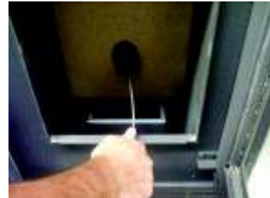
Fig. 45 - Limpieza con escobilla
