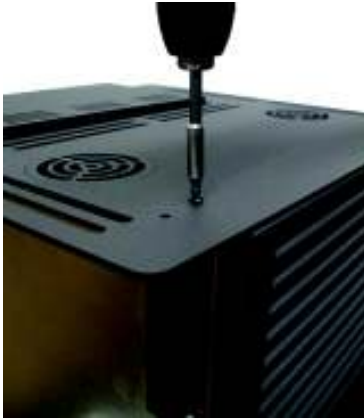
Fig. 19 - Extacción le los tornillos superiores
