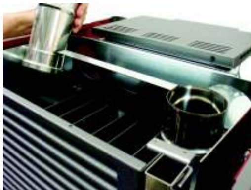
Fig. 31 - Posicionamiento superior de los tubos
