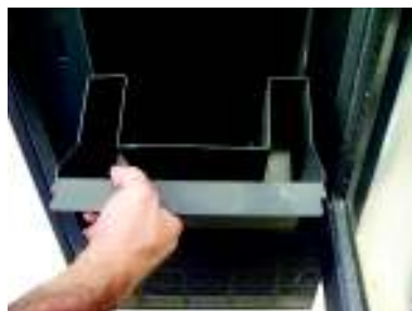
Fig. 41 - Extracción del cajón de cenizas
