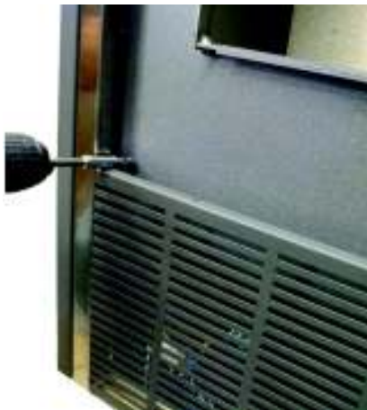
Fig. 53 - Extracción tornillos anteriores
