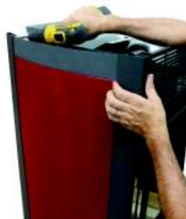
Fig. 18 - Reposición listones curvos superiores
