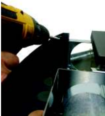
Fig. 15 - Extracción listones curvos superiores
